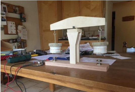
Figure 3 – Les bobines sont mobiles et se déplacent verticalement autour des aimants fixes.
