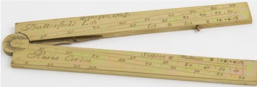
Abbildung 3: Dieser Proportionalwinkel (um 1700) von Michael Butterfield hat auf jeder Seite vier Skalen. Für die Nutzung braucht man einen Stechzirkel. Quelle: Science Museum, London
