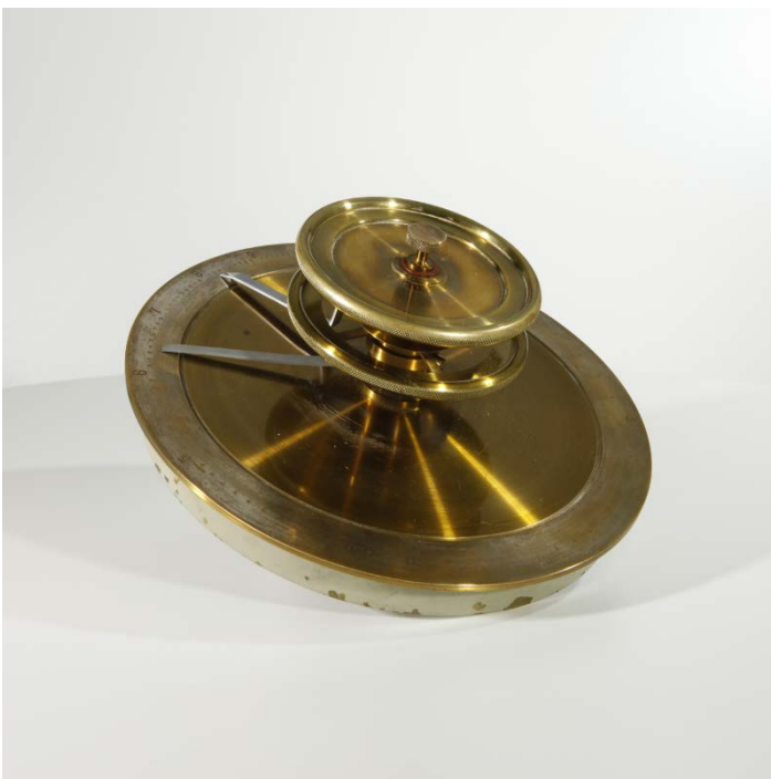
Abbildung 2: Webersche Rechenscheibe mit fester Grundplatte, drehbarem Ring und drehbarer Scheibe (© ETH-Bibliothek Zürich)
