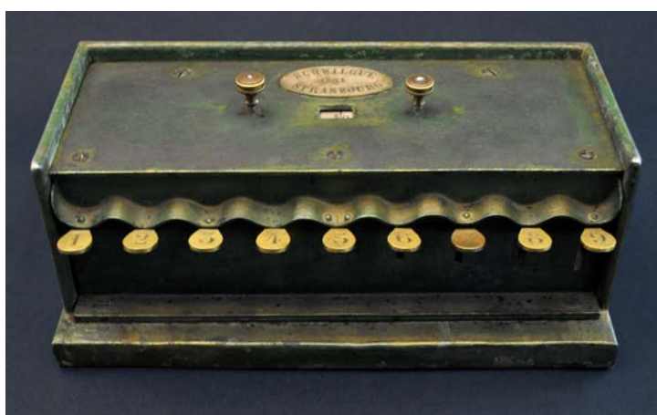
Bild 2: Schwilgué-Tastenaddierer (1851) aus der Sammlung Sternwarte der ETH-Bibliothek: besterhaltene, älteste Tastenaddiermaschine der Welt, erfunden von Schwilgué, dem Schöpfer der derzeitigen astronomischen Uhr des Strassburger Münsters, © Herbert Spühler, Stallikon
