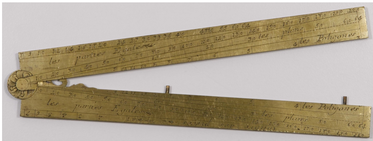
Abb. 1: Proportionalwinkel (Gerät). Proportionalwinkel haben im Unterschied zum Reduktionszirkel ein festes, nicht verschiebbares Scharnier (© ETH-Bibliothek Zürich, Sammlung Sternwarte).
